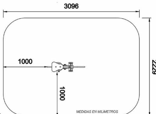
Se deberá instalar el equipo sobre una superficie de áridos (arena, gravilla, etc.) o sobre un suelo amortiguador de impactos (baldosas de caucho), siendo este último el más aconsejable y seguro. Su espesor irá en función de la altura de caída libre del equipo.
