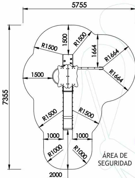
Se deberá instalar el equipo sobre una superficie de áridos (arena, gravilla, etc.) o sobre un suelo amortiguador de impactos (baldosas de caucho), siendo este último el más aconsejable. Su espesor irá en función de la altura de caída libre del equipo.
