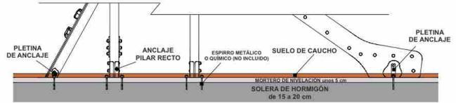
INSTALACIÓN EN SUELO DE HORMIGÓN
