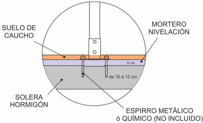
Se deberá instalar el equipo sobre una superficie de áridos (arena, gravilla, etc.) o sobre un suelo amortiguador de impactos (baldosas de caucho), siendo este último el más aconsejable. Su espesor irá en función de la altura de caída libre del equipo.
